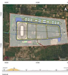
Preenchimento das células 1 e 5 (2029-2035) - Primeira fase operacional, onde as células são preenchidas de acordo com o plano de avanço do aterro. O perfil A-B mostra o preenchimento inicial dessas células, com destaque para o volume de resíduos e solo utilizados nesta etapa.
