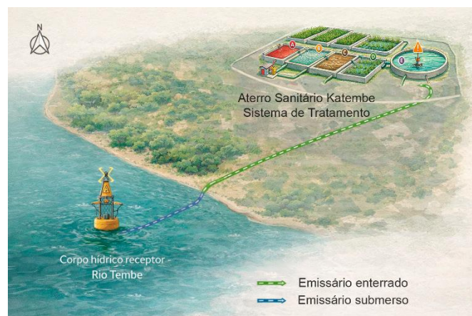
Esquema ilustrativo da descarga do efluente tratado: Sistema de Tratamento -> Meio receptor do Rio Tembe
