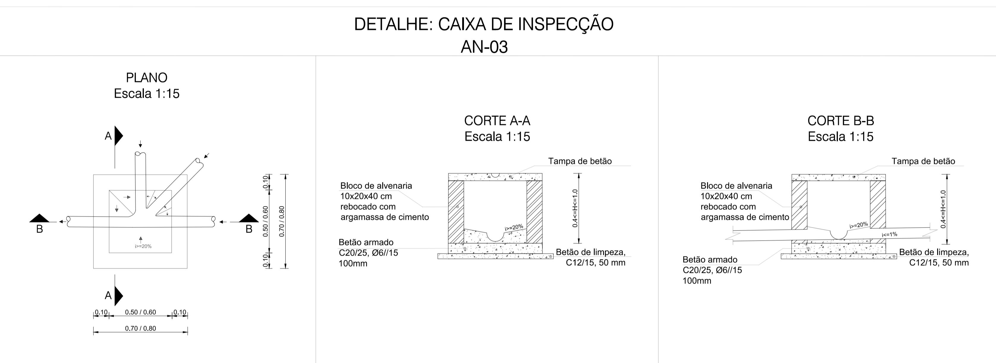
**DETALHE: CAIXA DE INSPECÇÃO
