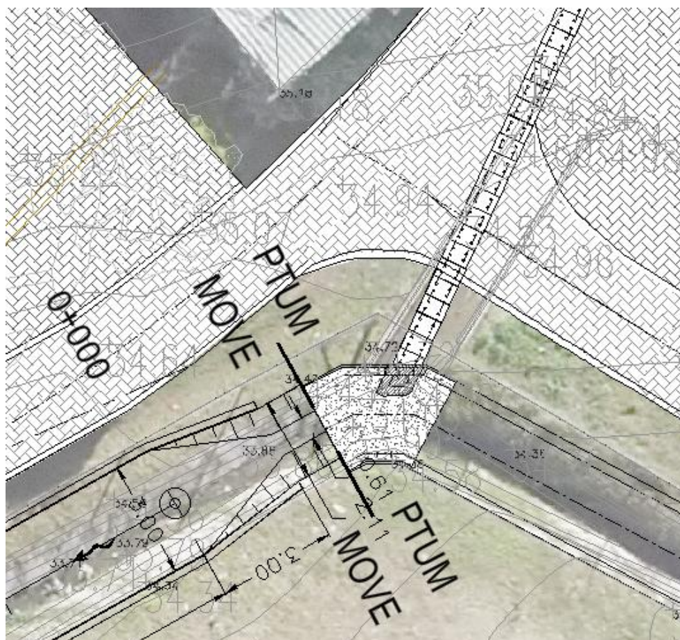
Figura 3-3: Malanga – Intervenção complementar – Cobertura da curva da vala existente
