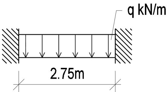
$$q = (20 \times 2,4 + 10 + 0,3 \times 25) = 65,5 \text{ kN/m}$$
