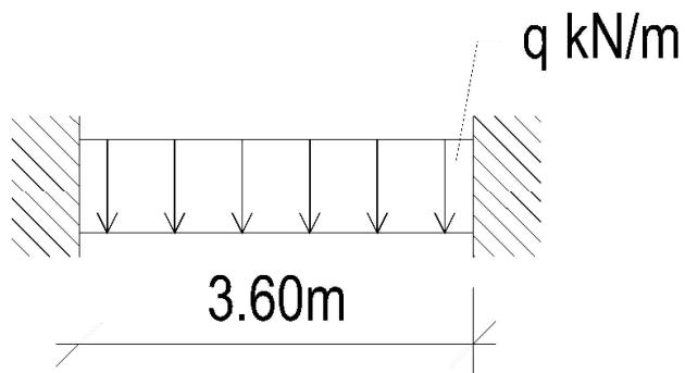
$$q = (20 \times 2,35 + 10 + 0,3 \times 25) = 64,5 \text{ kN/m}$$
