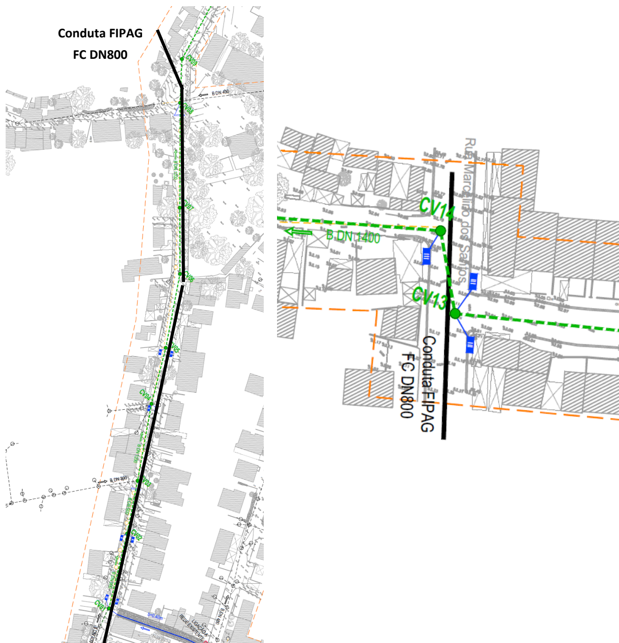
Figura 6.4 – Condicionante 1 – Conflitos da Solução Proposta com a Adutora FC DN800 – Cadastro de 2025
