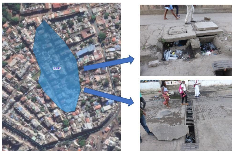
Mapa 2-4: Localização da área inundável da rua Estácio Dias e fotografias que demonstram o mau estado de conservação das infra-estruturas existentes de drenagem.
