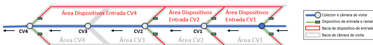
Figura 1.6 – Delimitação de bacias para dimensionamento de troços de rede e dispositivos de entrada
