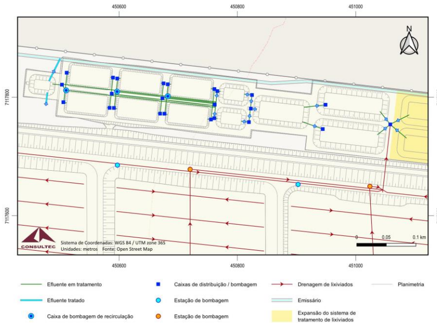
Figura 4-13 Circulação e Recirculação do efluente
