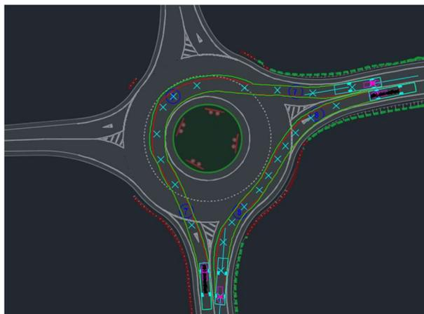
Figura 20 - Trajetórias geradas pelos autocarros (Rotunda 2).
