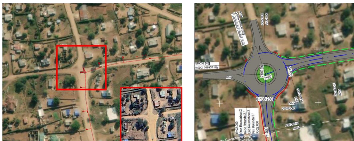
Figura 8-2 Intercepção entre o troço B e C e Rotunda 2 proposta
